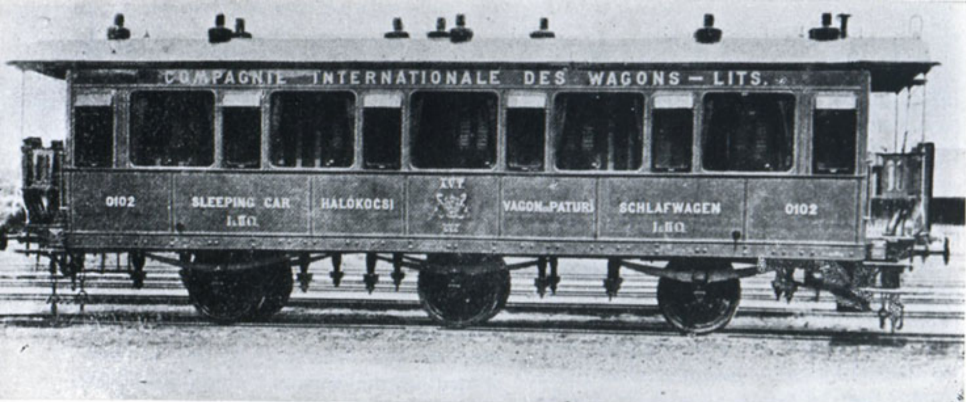
Voiture-lits n° 102, 1 re et 2 me classes (8-6) 14 places, construite à Munich en 1881, parachevée aux Ateliers de Saint-Ouen en 1882, en exploitation en Autriche-Hongrie et en Roumanie. (Photo Rathgeber - Collect. R. Commault - Cliché « Chemins de fer ».)
