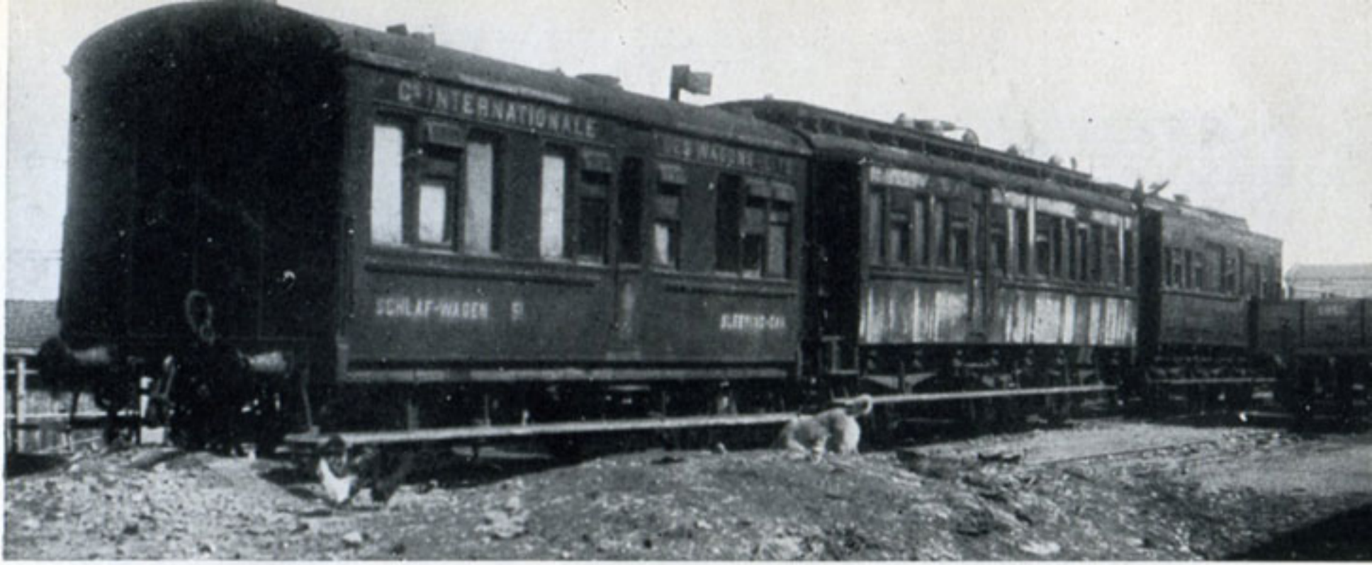
Document unique ou photo prise à Constantinople vers 1895 de GAD WL n° 51 (2 essieux, 1875), WL n° 26 (3 essieux, 1874), WL-Salon n° 43 (3 essieux, 1875). (Photo The Locomotive Pub. - Cliché « Chemins de fer ».)
